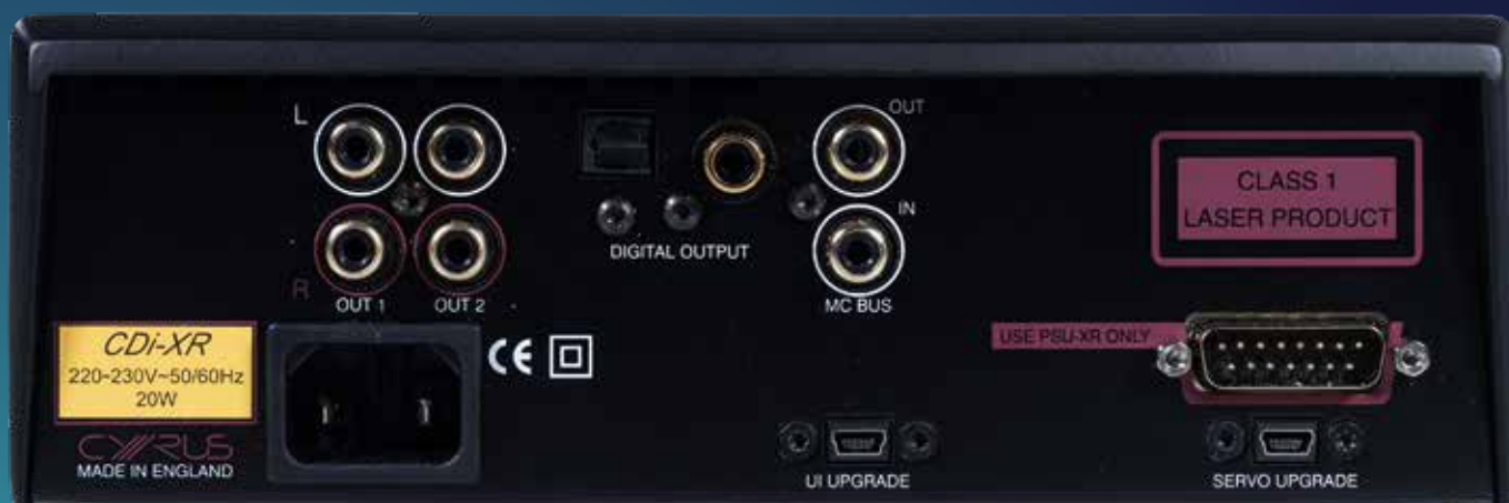
Der CD-Player CDi-XR hat neben zwei digitalen Ausgängen auch zwei analoge. Diese sind mit einem fantastischen Vorverstärker ausgestattet, so dass wir diesen Anschluss immer dem digitalen vorziehen
