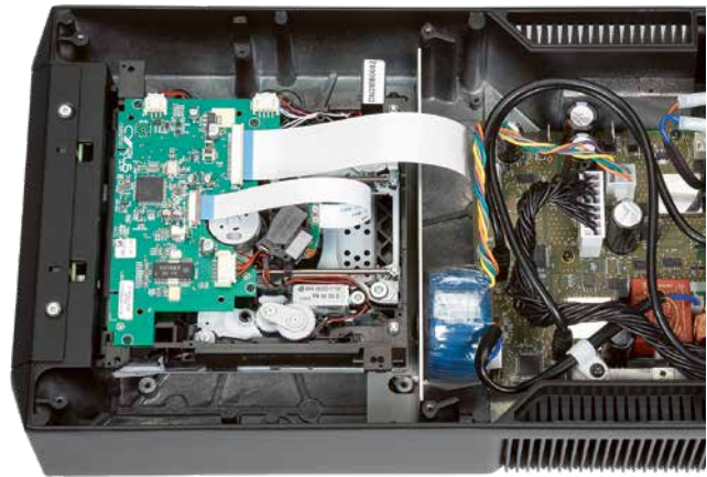
Als Laufwerk des Cyrus CDi-XR wählten die Briten einen besonders robusten Slot-In-Typ und gewährten ihm eine exzellente Servo-Steuerung.
