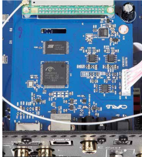
So sieht die Digital-/Streaming-Platine im ONE CAST aus. Sie bietet die wichtigsten Anschlüsse.
