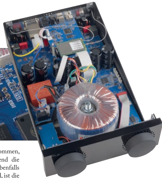
Cyrus setzt seit jeher auf eine gute Stromversorgung und platziert einen mächtigen Ringkerntrafo in der vorderen Hälfte des Verstärkers
