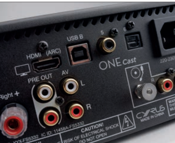
Mit dem HDMI-Input auf der Rückseite bietet sich der Verstärker auch für die Wiedergabe von Film- und Fernsehton an
