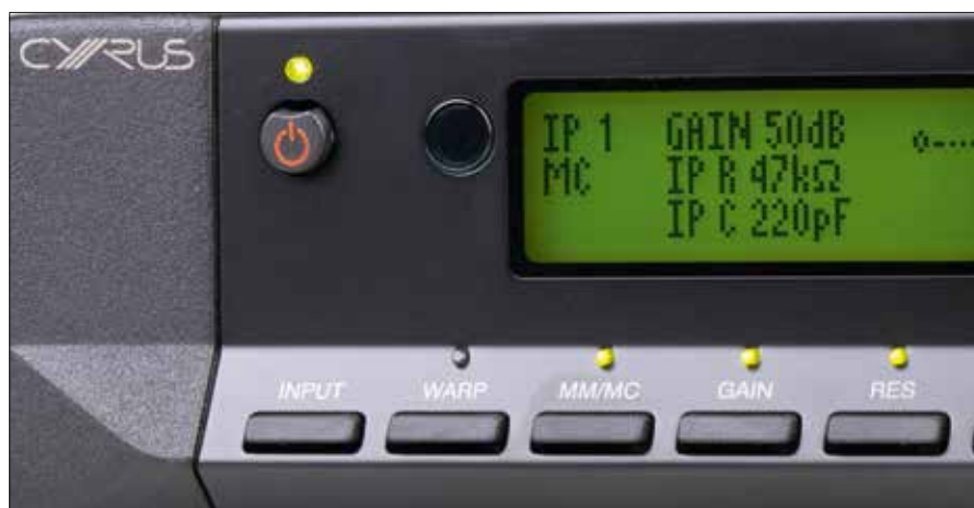
Über das gut lesbare, dreizeilige Display werden eine ganz Menge Informationen dargestellt, darunter Bauform, Gain, Widerstand und Kapazität der Vorstufe
