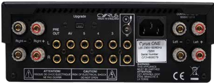
Dank des USB-Eingangs ist die Software des Cyrus One upgrade-fähig. Der Bi-Wiring Anschluss der Lautsprecher ist ebenfalls möglich
