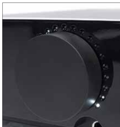
Balanceregulierung – die obere leuchtende LED zeigt hier an, wie weit die Balance nach links verschoben wurde
