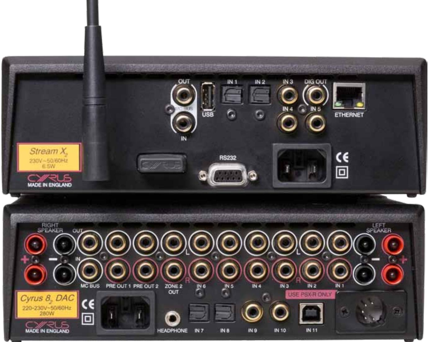
Der Stream X Signature muss sich mit lediglich einem Ausgang begnügen, verfügt dafür jedoch über eine ausgeprägte Eingangssektion mit 5 Digitaleingängen, Ethernet, WLAN und USB. Der 8<sub>2</sub> DAC lässt bezüglich der Anschlüsse kaum Wünsche offen. Zahlreiche Analogeingänge nebst vollwertiger Digitalsektion und Vorstufenausgänge sowie ein Ausgang für eine zweite Zone stehen hier zur Verfügung
