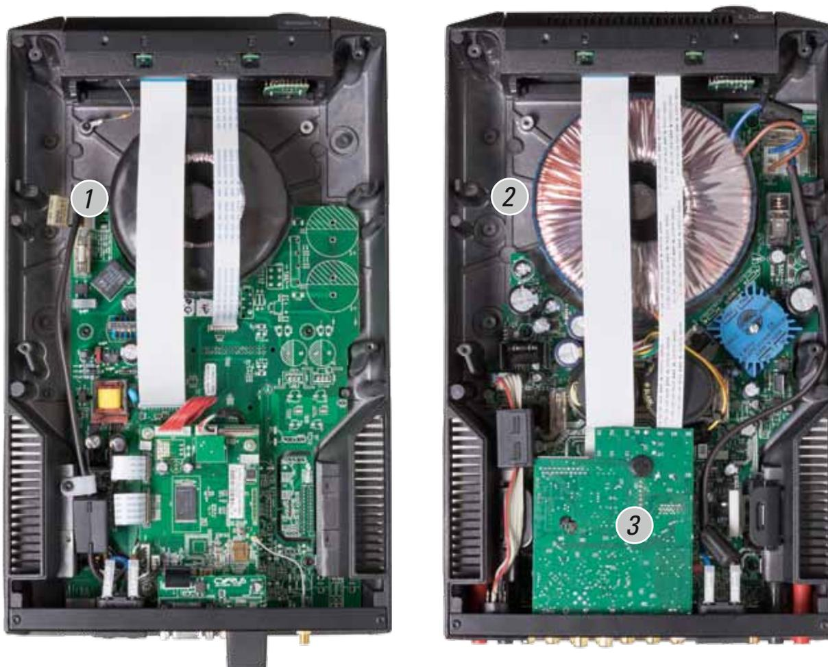
Bei Cyrus steht die Welt Kopf. Die Platinen sind an der Oberseite verschraubt. Sämtliche Elemente hängen also an der Decke. Sowohl ① Streamer als auch ② Vollverstärker werden von Ringkerntransformatoren mit stabiler Spannung gefüttert, welche einen beträchtlichen Teil deren Gewichts ausmachen. ③ Im Vollverstärker sitzt die Digitalektion als separate Platine „on top“ auf der Haupteinheit
